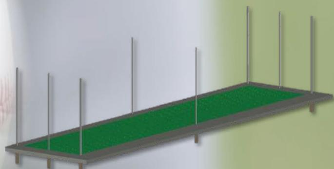
Estructura para colocación de jaula de bateo profesional de 21m de largo 3.8m de alto y 4m de ancho
